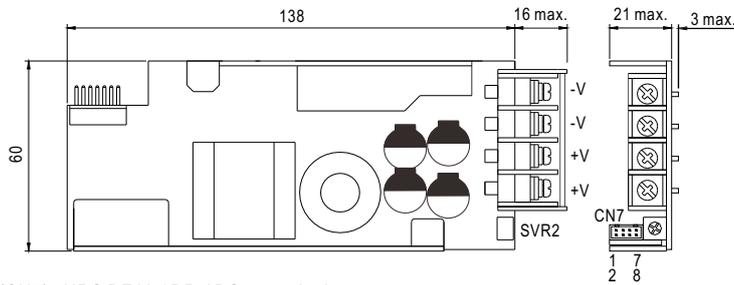
Output Connector(CN7) : HRS DF11-8DP-2DS or equivalent
